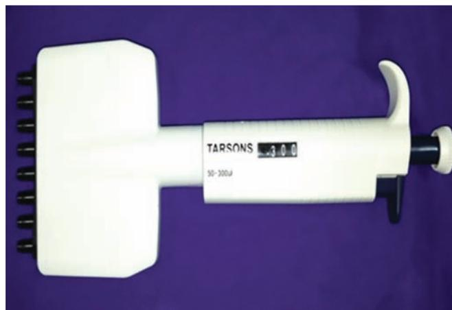
Fig. 3: Microtitre pipettes
