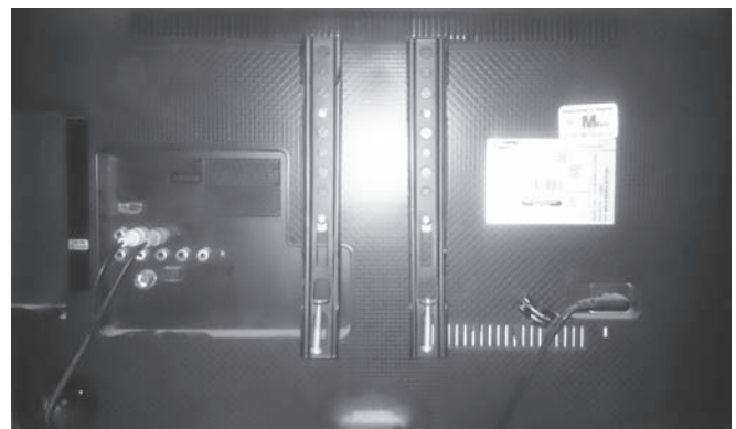
Fig. 8: Monitor back showing AV connection cable
